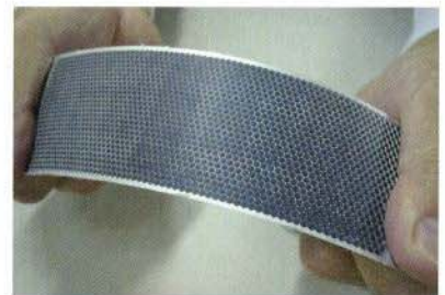
写真2 | 曲面化できる太陽電池
